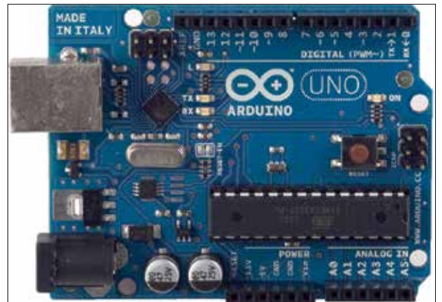
Şekil 3. Arduino mikro kontrolör panosu.
