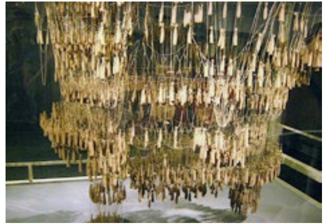
Şekil-6: Gaudi'nin kablolu güçleri incelemek için kullandığı zincir eğrisi (catenary) tasarım modeli
