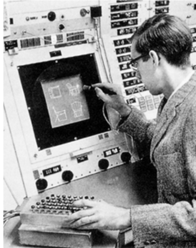
Şekil-1: Ivan Sutherland'a ait SKETCHPAD. Kullanıcı 7'ye 7 inç aralıklı bir cihazda 1024'e 1024 bir ızgara üzerinde bir ışık kalemi kullanarak “çizim” yapar ve diğer eliyle de komut düğmelerine basar. “Hypertext ve GUI'lerin Vizyonu ve Gerçek Durumu (Vision and Reality of Hypertext and GUIs): 3.1.2. Sketchpad - mprove.de”, http://www.mprove.de/diplom/text/3.1.2_sketchpad.html .
