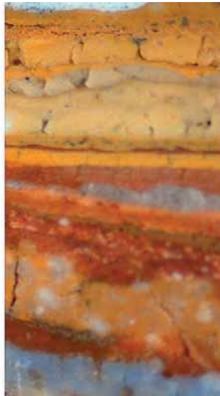
Resim 6. Bursa Muradiye Meydanında tarihi bir yapı ve stereomikroskop ile incelenen kalın kesitte görülen boya katmanları. Laboratuvar analizleri bugün beyaz olan yapının ilk döneminden bu yana 19 ayrı renk katmanına sahip olduğunu göstermektedir. Bakım ve onarımlara sıkça uygulanan sıva raspası nedeniyle, bu örnekte olduğu gibi, tarihsel süreklilik içinde oluşmuş boya katmanlaşmasının izlenebildiği örnek sayısı oldukça azdır. (ODTÜ Araştırma Fonu Projesi BAP-2004-02-01-05)
