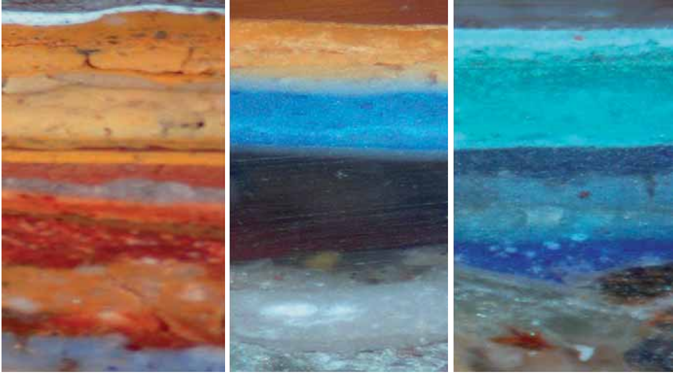
Resim 7. Bursa Muradiye Mahallesi'nde bulunan tarihi yapıların stereomikroskop ile incelenen kalın kesitte görülen boya katmanlarına örnekler. (ODTÜ Araştırma Fonu Projesi BAP-2004-02-01-05)
